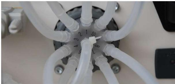
Befestigen Sie den dünnen Schlauch mit einem Kabelbinder am rechten Reduzierstück. Verbinden Sie den dünnen Schlauch mit dem Einlassanschluss des Ventils (nicht nummerierte Position in der Mitte) und befestigen Sie ihn mit einem Kabelbinder. Verbinden Sie 10 dünne Schläuche mit jedem nummerierten Anschluss.
