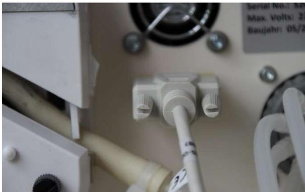
Schließen Sie das Datenkabel auf der Rückseite des Färbeautomaten an.
