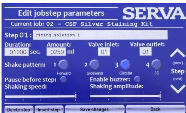
Wählen Sie den zu bearbeitenden Schritt aus, indem Sie die Auf- und Abwärtspfeile drücken.
