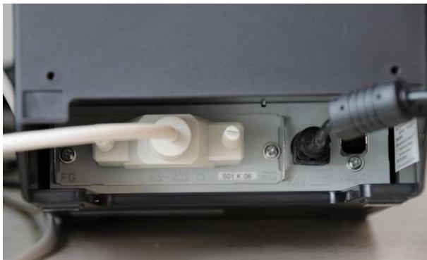
Schließen Sie das Datenkabel auf der Rückseite des Druckers an und verbinden Sie es mit dem Stromnetz.
