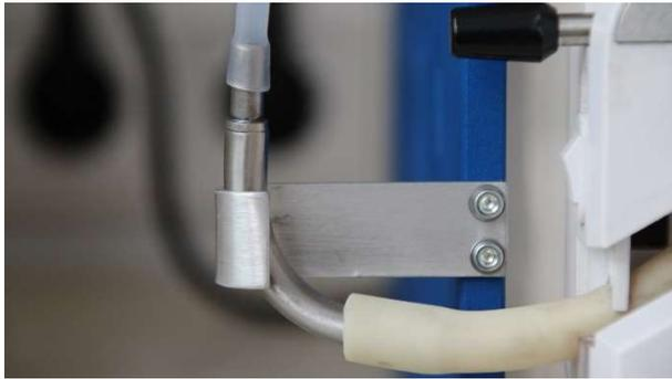
Stellen Sie die Färbeschale mit dem Aus- / Einlauf Richtung rechts hinten auf den Schütteltisch. Verwenden Sie einen dünnen Schlauch, um den Aus- / Einlass des Tisches mit dem Reduzierstück zu verbinden.
